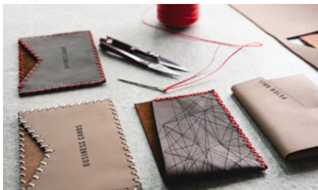
Estetyczne, idealnie zasklepione krawędzie laserowo ciętej skóry z wygrawerowanymi detalami
